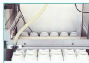
Сопло XY распределителя в крайней передней левой позиции
